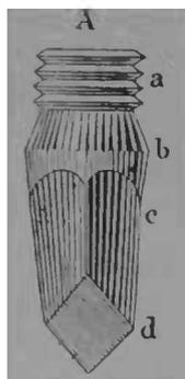
Fig. 159. — Vis quadrangulaire à tenon tronconique pour mortaise en cuvette (Aureggio).
