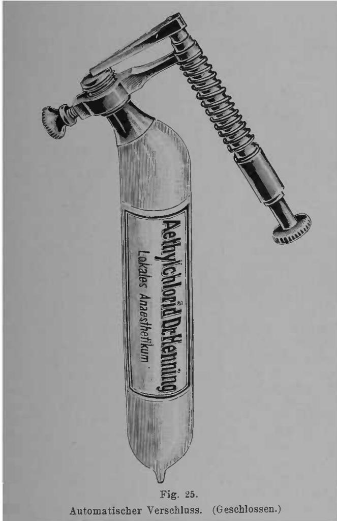
hebel weicht nach rechts aus (Fig. 26). Sobald man den Daumen loslässt, schnappt der Verschluss selbstthätig wieder zu. Damit nun bei länger dauernder Zufuhr der Daumen durch die fortgesetzte Spannung nicht ermüdet, ist an dem Apparat noch eine Arretierungsvorrichtung angebracht (Fig. 26a), die aber erst in
