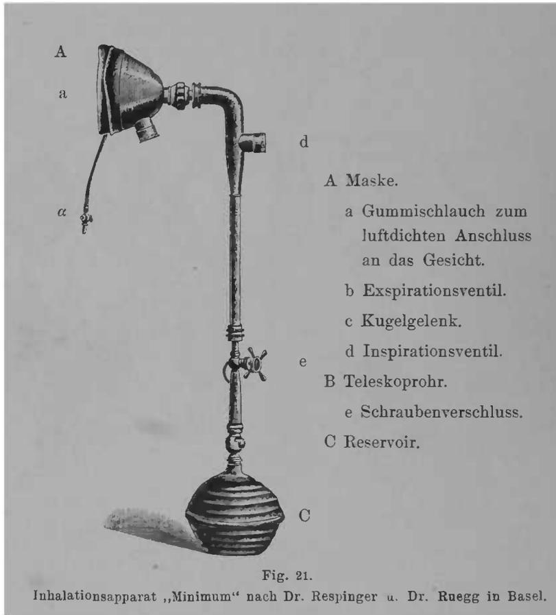
struiert (Fig. 21). Derselbe besteht, wie aus der Abbildung ersichtlich ist, aus einer luftdicht anschliessenden Maske mit Expirationsventil, dem damit gelenkig verbundenen, mit zwei Inspirationsventilen versehenen Ansatzrohre, dem 1 kg Chloräthyl enthaltenden, der Spannung entsprechend konstruierten, mit Schraubenverschluss und Abstellhahn versehenen Reservoir und dem das
