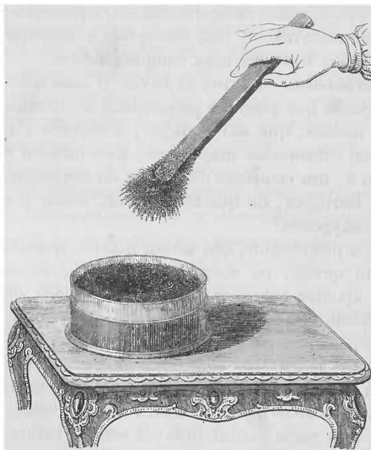
Fig. 301.— Iman attrahindo a limalha de ferro.
